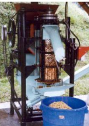
Figura 1. Modelo BECOLSUB 1600 con capacidad para procesar 1000 kg de café cereza por hora, construido en Cenicafé.
