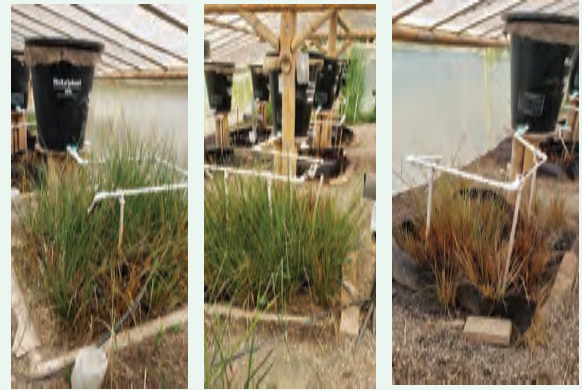
Figura 54. Aspecto de los filtros verdes 4, 5, 6 al final de la tercera aplicación de agua.
