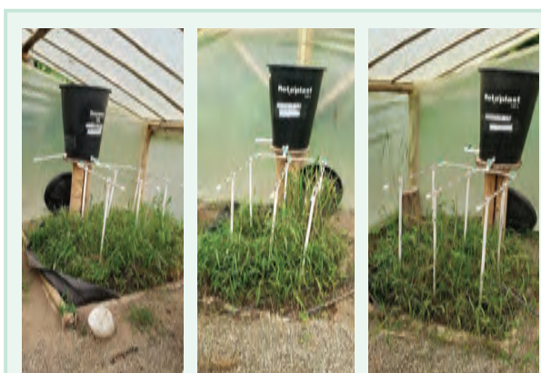
Figura 47. Aspecto de los filtros verdes 13, 14, 15 al final de la primera aplicación de agua.
