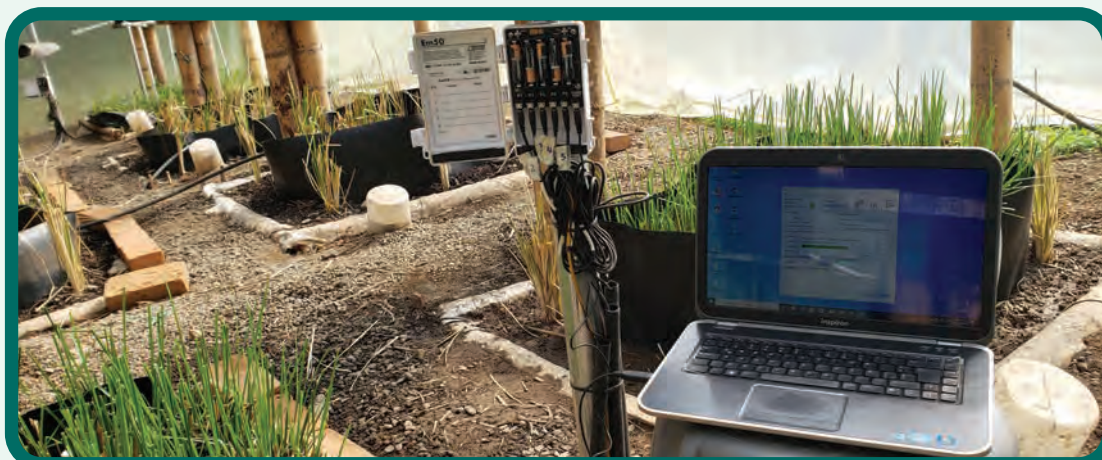
Figura 68. Aspecto de la descarga de datos almacenados en los datalogger.
