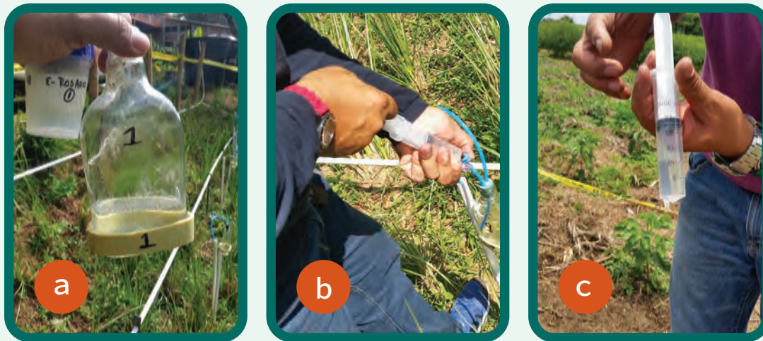
Figura 10. Muestreo del agua de salida del filtro verde. a. Aspecto del agua de salida de los filtros verdes; b. Toma de muestra de la cápsula de succión en los filtros verdes con pasto vetiver; c. Aspecto del agua de la cápsula de succión.
