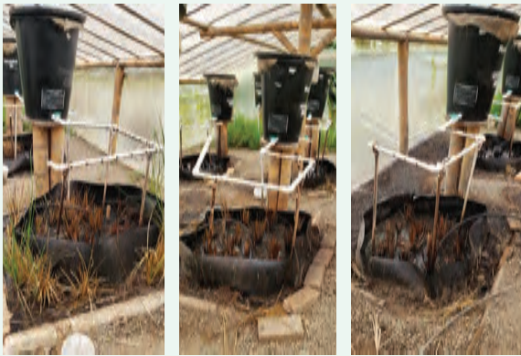
Figura 55. Aspecto de los filtros verdes 7, 8, 9 al final de la tercera aplicación de agua.
