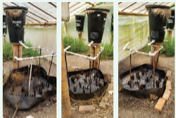
Figura 56. Aspecto de los filtros verdes 10, 11, 12 al final de la tercera aplicación de agua.
