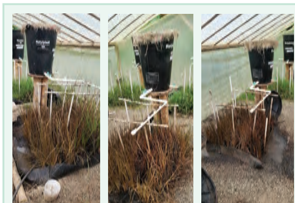
Figura 46. Aspecto de los filtros verdes 10, 11, 12 al final de la primera aplicación de agua.
