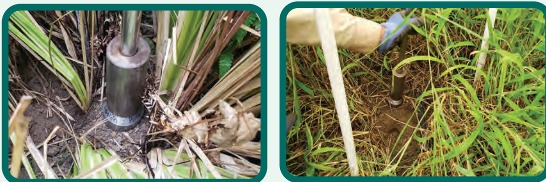
Figura 39. Muestreo de suelo para la determinación de propiedades físicas.
