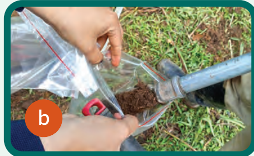
Figura 21. Muestreo del suelo; a. Muestreo del suelo para determinar sus características físicas; b. Muestreo del suelo para determinar sus características químicas.
