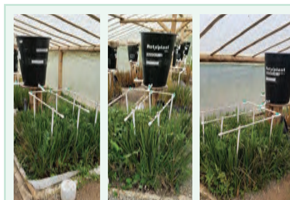
Figura 43. Aspecto de los filtros verdes 1, 2, 3 al final de la primera aplicación de agua.
