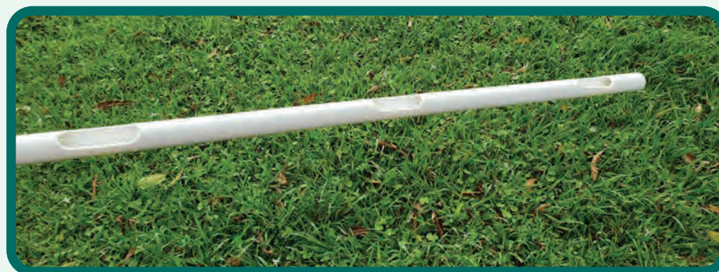
Figura 94. Canales de descarga, por rebose, de la tubería de riego.
