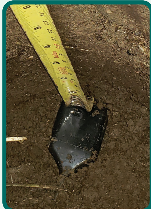
Figura 32. Ubicación del sensor a 30 cm de profundidad del filtro verde.
