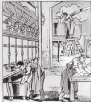
Pour éviter l'évaporation de leur arôme, les grains de Café sont envelopés d'une couche mince mais continue de sucre caramélisé par la vapeur, puis refroidis le long d'un mur de longues tables métalliques. Cet envelopage et ce brisage refroidissent également toute évaporation. Le Café passe alors aux machines qui le réduisent en poudre.
