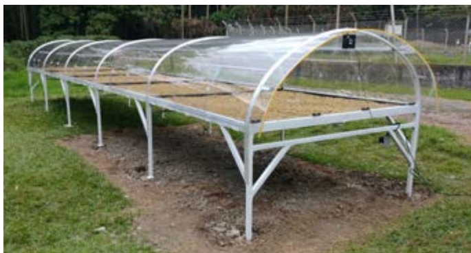
Figura 80. Figura 14. Secador solar tipo túnel con cubierta en policarbonato macizo color cristal.
