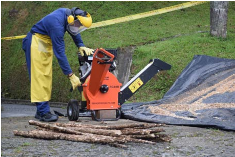
Figura 82. Chipeadora utilizada para astillar tallos de café.
