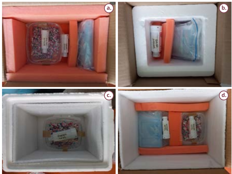
Figura 26. Empaques evaluados. a. Caja de cartón forrada con poliuretano; b. Caja de cartón con nevera de icopor en el interior y cerrado hermético; c. Caja de cartón con nevera de icopor en el interior forrada con thermolon con cerrado hermético; d. Caja de cartón forrada con thermolon. La nevera de icopor del empaque b y c se diferencian en el espesor del icopor, siendo la b más gruesa.
