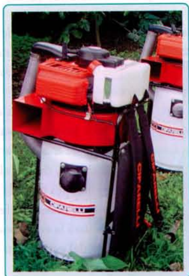
Figura 42. Dispositivo Cifarelli V77S comercialmente para coger castañas, nueces y aceitunas
