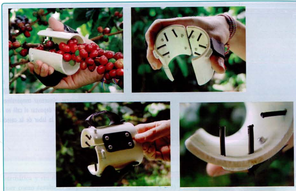
Figura 46. Dispositivo de asistencia RASELCA II . Detalle de la bisagra plástica de poliuretano remachada al dispositivo y el diente en forma de U pegado al dispositivo con soldadura epóxica estándar.
