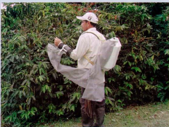
Figura 47. Conjunto del Aro y Manga con un Dispositivo de Espalda (equipo AM&DE) para capturar, almacenar temporalmente en la manga y depositar el café en la espalda, durante la labor de la cosecha manual asistida.
