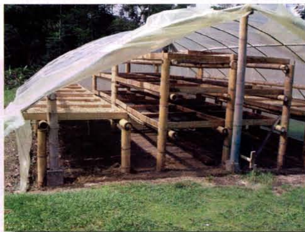
Figura 33. Secador Solar Parabólico para 200 @ cps/año - SSP 200. Se observan: dos alas o laterales con bandejas (alas 1 y 2) y un sector central con bandejas dispuestas en tres niveles (alas C1 y C2).
