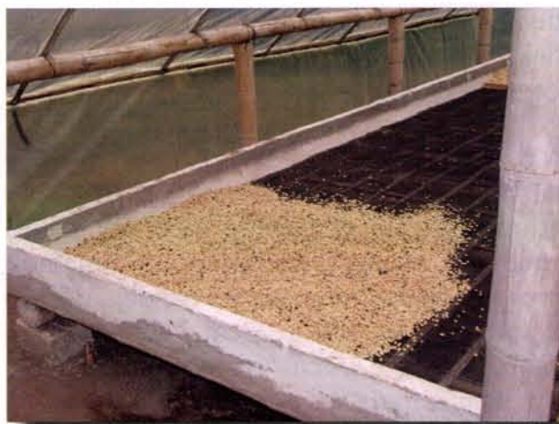
Figura 32. Secador solar parabólico para 120@ cps/año-SSP-120. Vista de lateral del secador y el café colocado sobre la malla referencia 5000 negra.
