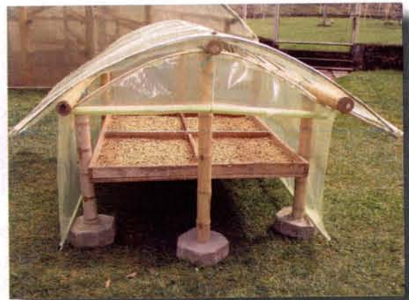
Figura 31. Secador solar parabólico para 15@ de cps - SP15. Vista general del SP15, destacándose, la cubierta parabólica plástica, la estructura en guadua, los cubrimientos laterales, de enrollar, tipo cortina y la bandeja interior con café.
