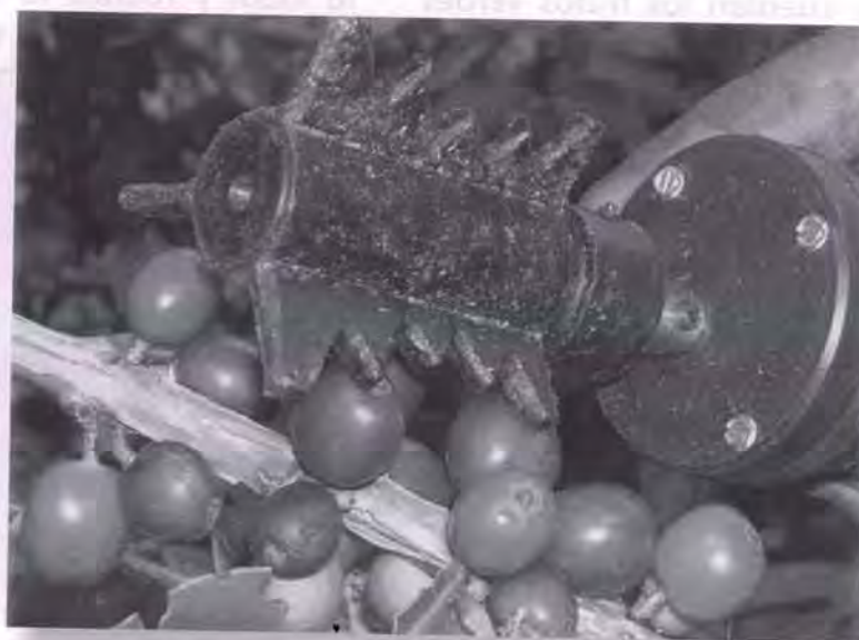
■ Figura 24. Impactador, diseñado para la herramienta IMFRA 3VDC.
