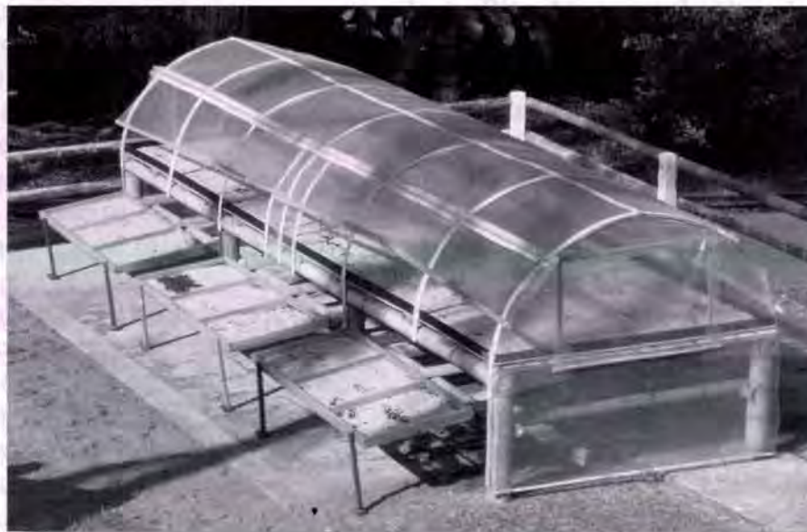
■ Figura 26. Secador solar tipo túnel con piso en malla plástica "sarán" de 45% (12 m 2 ) y bandejas laterales para facilitar el proceso de secado.
