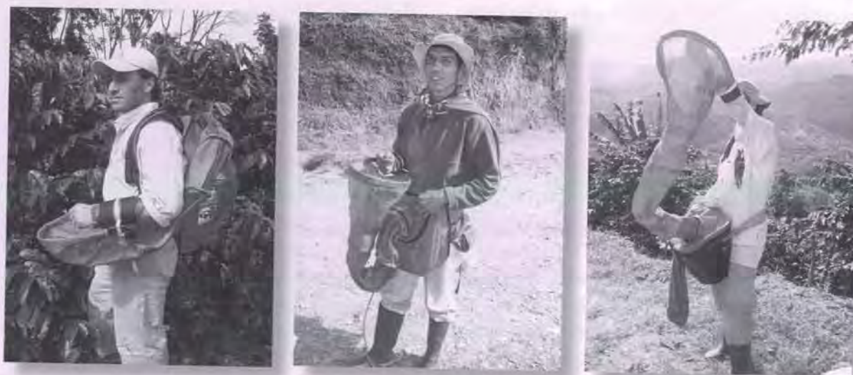
■ Figura 23. Dispositivos Aroandes, CanguAro y AroCoco, desarrollados en Cenicafé para asistir la cosecha manual de café.
