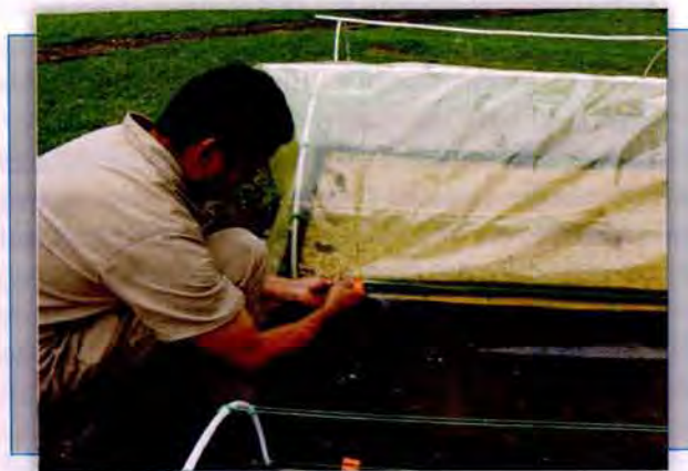
■ Figura 70. Modelo de secador de túnel solar de rápido ensamble.
