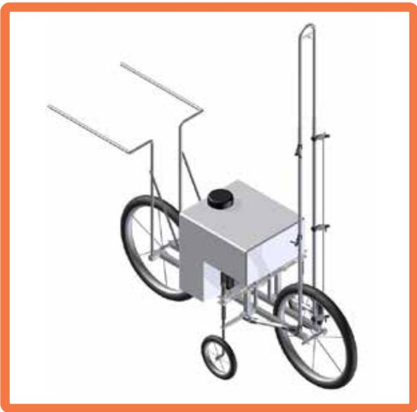
Figura 47. Concepto de un equipo para la aspersión de pesticidas en el cultivo del café en Colombia.
