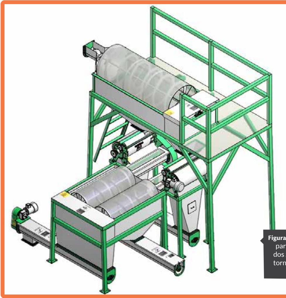
**Figura 35.** Banco de despulpado con zaranda para café en cereza, dos despulpadoras, dos zarandas para café despulpado y tres tornillos sinfín de descarga de pulpa, café despulpado y pasillas.
