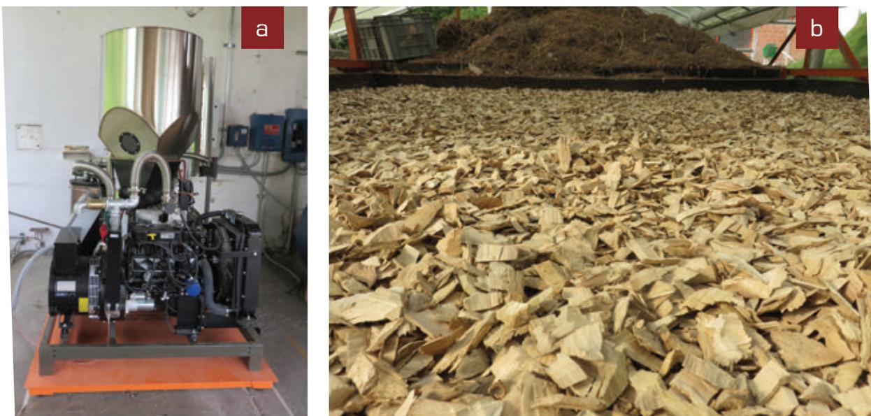
Figura 37. Equipo utilizado para generar energía eléctrica [a] y chips de madera del café para el funcionamiento del gasificador [b].
