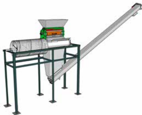
Figura 27. Despulpadora con zaranda y tornillo para el transporte de la pulpa.
