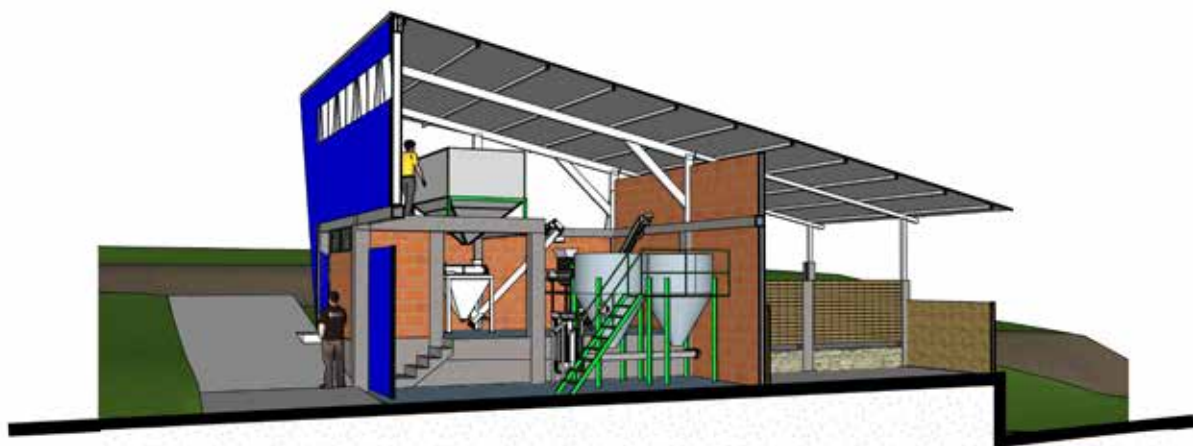
Figura 42. Corte general con vista de la maquinaria del beneficiadero ecológico comunitario de La Sierra.
