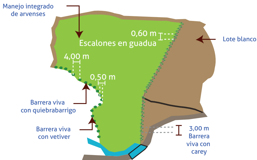
Figura 153. Diseño con prácticas y acotaciones en conservación de suelo y agua en el municipio de Salamina, Caldas.
