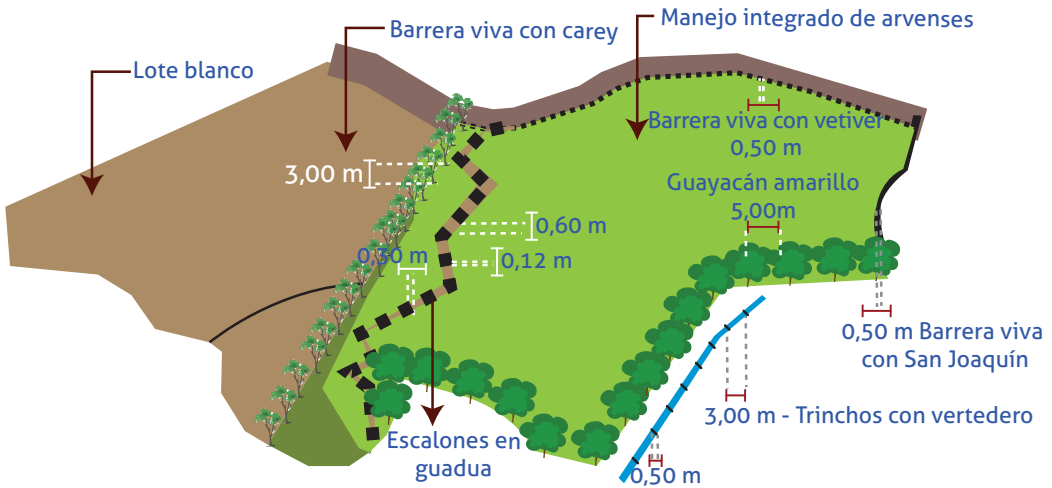
Figura 165. Diseño con prácticas y acotaciones en conservación de suelo y agua en el municipio de La Unión, Nariño.
