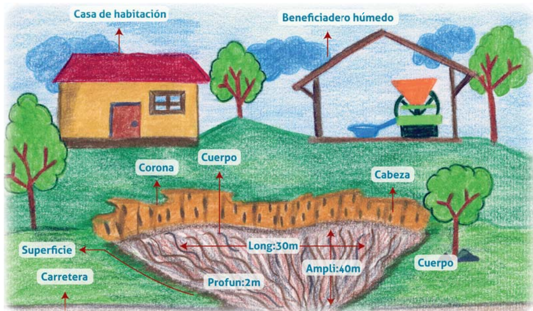
Figura 5. Esquema de un deslizamiento realizado por el técnico GIA en compañía de la comunidad, para la microcuenca La Chorrera, en el municipio de Inzá, Cauca.
