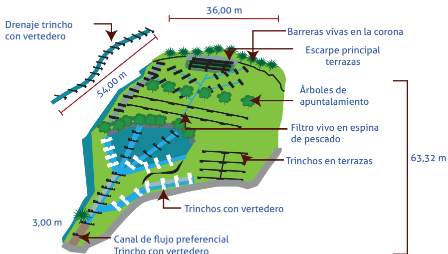
Figura 92. Diseño con las diferentes obras y acotaciones para restauración ecológica en el municipio de Aguadas, Caldas.
