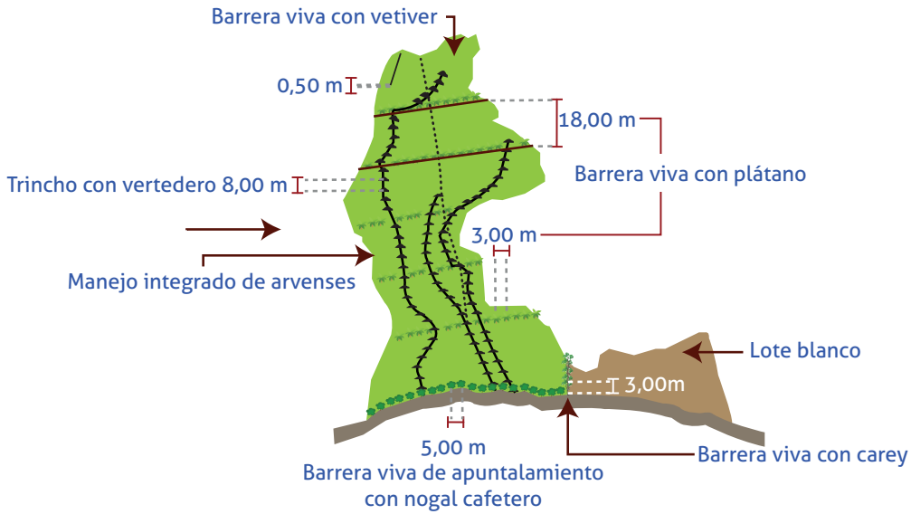
Figura 157. Diseño con prácticas y acotaciones en conservación de suelo y agua en el municipio de Pensilvania, Caldas.
