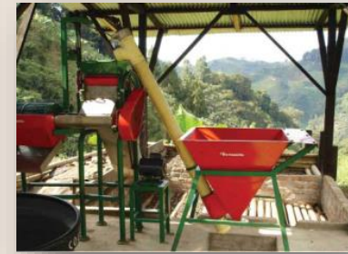
Separador hidráulico de tolva y tornillo sinfín
