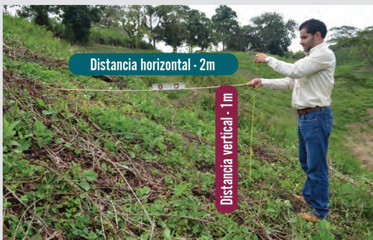
**Figura 20.** Medición de la pendiente en el terreno.
