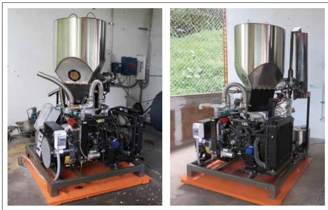
Figura 1. Unidad utilizada para generar energía eléctrica GEK 20 kWe (UGEE) a partir de astillas de madera de café.
