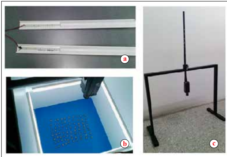
Figura 2. Sistema utilizado para la adquisición de las imágenes, a. Iluminación tipo LED; b. Campana de inspección con fondo de contraste; c. Cámara industrial de alta velocidad HS 2000C con bastidor de soporte.
