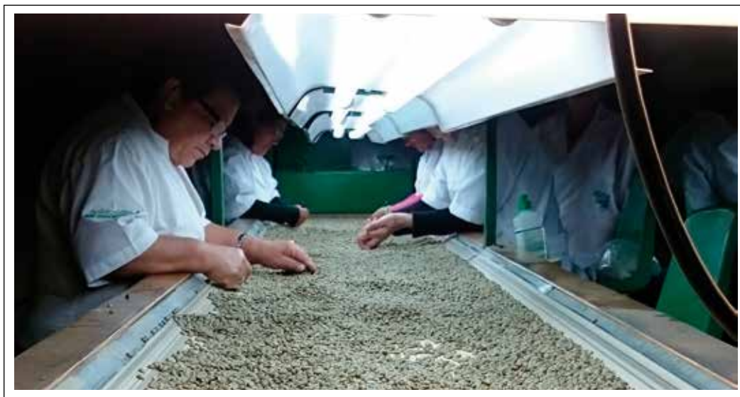
Figura 1. Clasificación manual del café almendra al final de los procesos industriales de clasificación automática en la trilladora.
