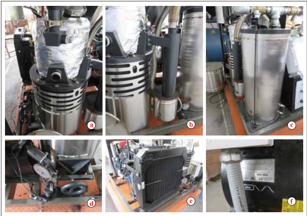
Figura 2. Componentes principales del gasificador: a. Reactor, b. Ciclón, c. Filtro, d. Sacudidor de la canasta donde se realiza el proceso de reducción, e. Motor de combustión interna, f. Generador.
