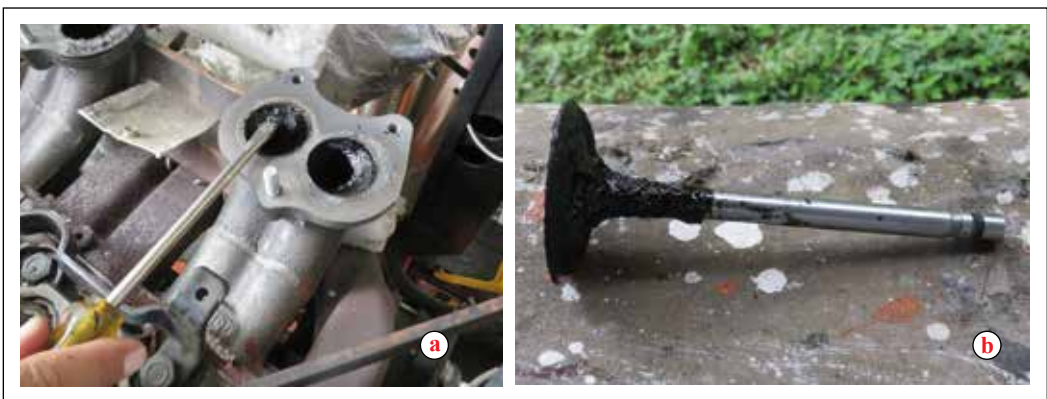
Figura 7. a. Presencia de alquitranes en el múltiple de admisión del motor de combustión interna del equipo GEK 20 kWe y b. válvula impregnada con alquitranes.
