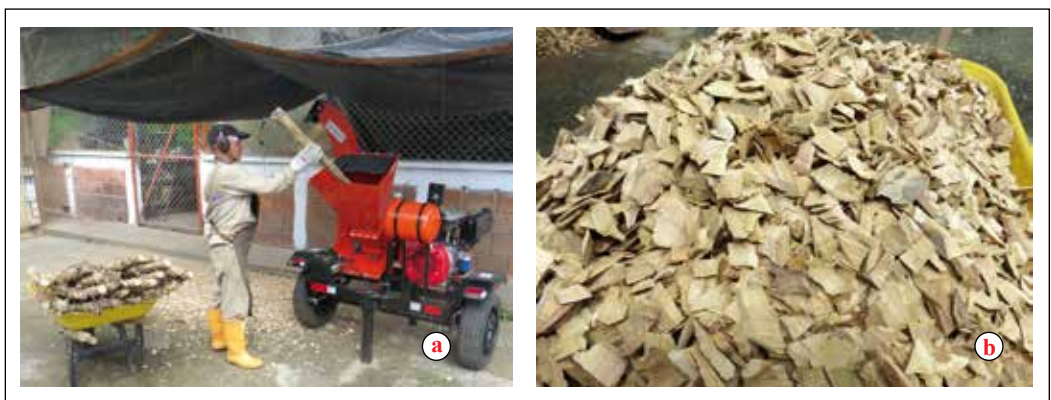
Figura 3. Obtención de astillas de la madera del café. a. Equipo utilizado, b. Astillas con las dimensiones recomendadas por el fabricante UGEE.
