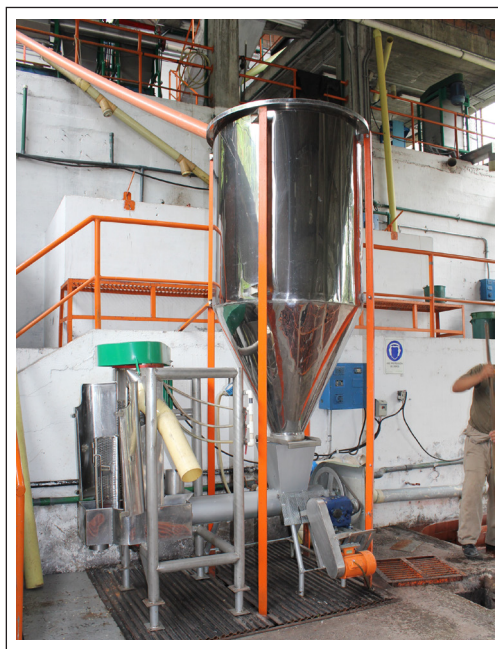
Figura 1. Equipo ECOMILL® 3000, utilizado en la evaluación del lavador de café con mucílago degradado por medio de la fermentación natural.
