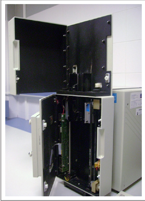
Figura 1. Equipo de mesa. Espectrofotómetro monocromador (Foss 6500).
