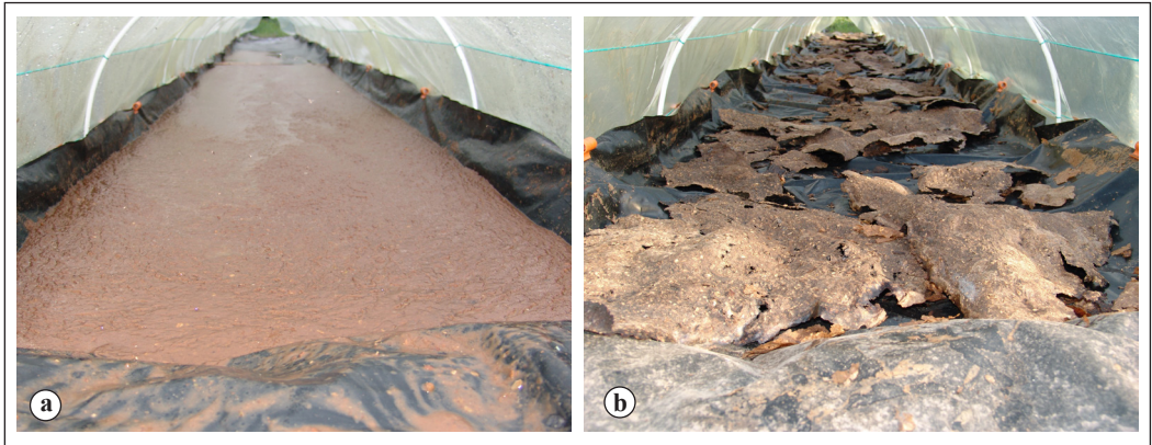
Figura 5. Secado solar de mieles resultantes del lavado del café. a. Vista interna del secador y b. mieles deshidratadas.
