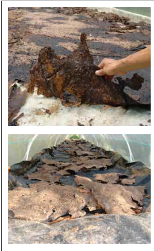
Figura 9. Efluentes deshidratados utilizando la energía solar.
