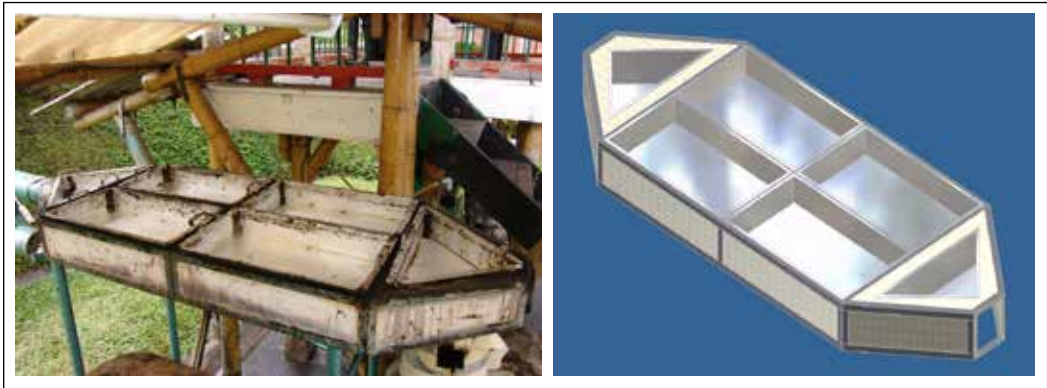
Figura 5. Dispositivo de bandejas para la evaporación de los lixiviados.
