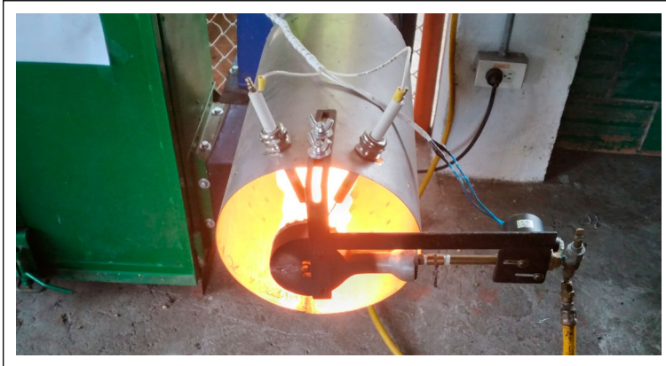
Figura 1. Apariencia de la llama en las pruebas de secado realizadas con combustión incompleta del GLP.
