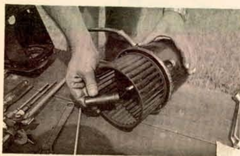
FIGURA 13.- Acople para transmitir movimiento del motor a la bomba.
