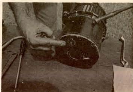
FIGURA 3.- Interruptor de seguridad.
