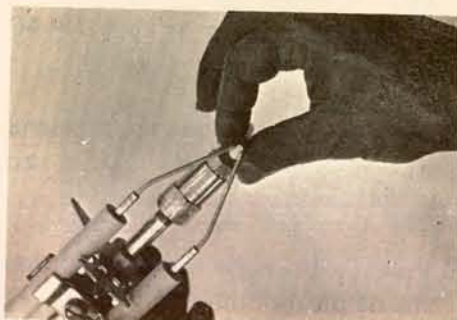
FIGURA 8.- Calibración de la distancia entre la boquilla y las puntas.
