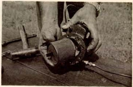
FIGURA 10.- Filtro de la bomba.
