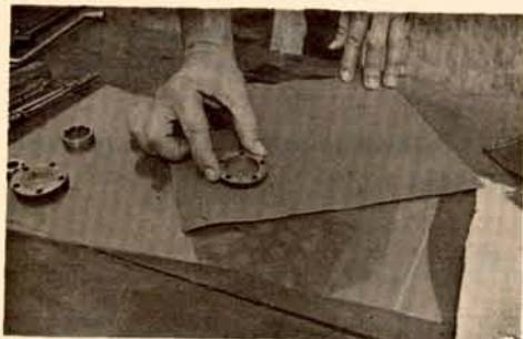
FIGURA 11.- Forma de limpiar los elementos de la bomba.
