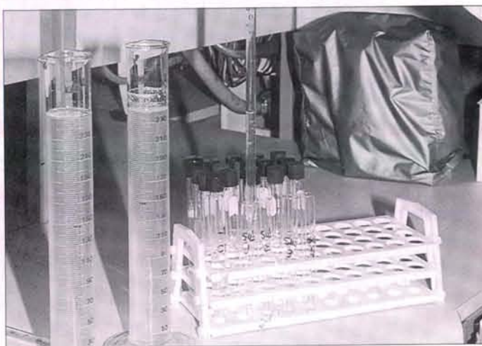
Figura 29. Suspensión de esporas (SE) a partir de la cual se establece la relación de esporas al tiempo cero (concentración inicial (CI)) y a los 50 minutos (concentración final (CF)) en la prueba de suspensibilidad
