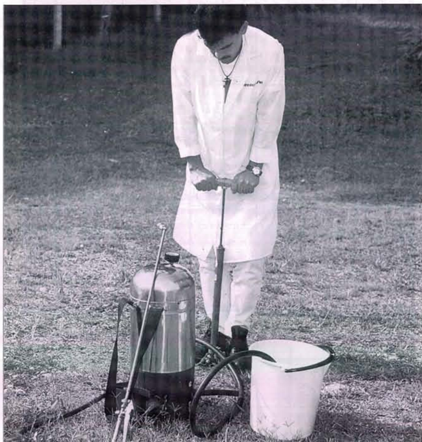
Figura 33. Depósito de la mezcla del hongo en el tanque de la aspersora, para la prueba de taponamiento de boquillas.
