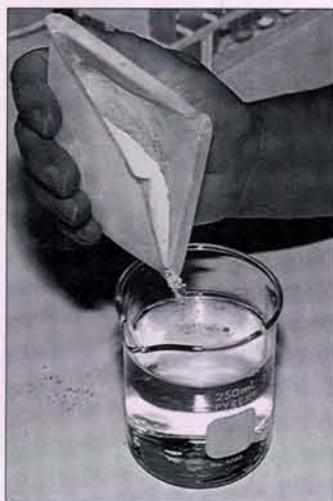
Figura 28. Muestra de un bioinsecticida en polvo sometida a determinación de humectabilidad en el laboratorio.
