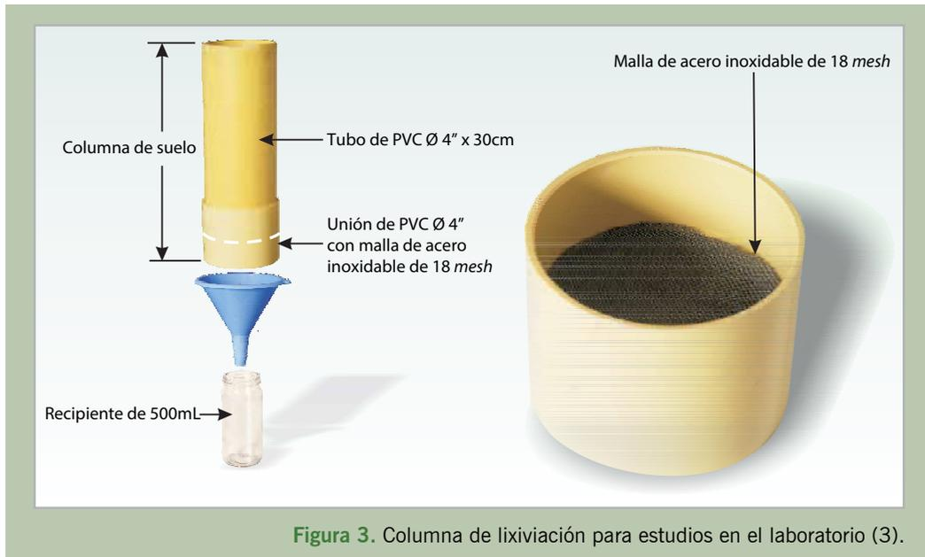
Figura 3. Columna de lixiviación para estudios en el laboratorio (3).
