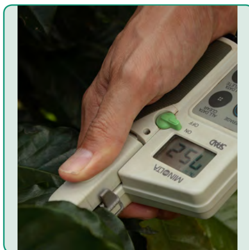
Figura 1. Medidor portátil de clorofila o clorofilómetro (SPAD-502; Spectrum Technologies).
