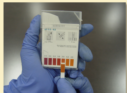
Lectura del pH del mucílago de café fermentado con tiras de color
