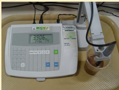
Medición del pH del mucílago de café fermentado con pH-metro
