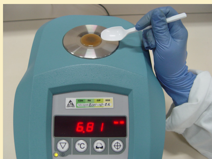
Medición de los °Brix del mucílago de café fermentado con refractómetro
