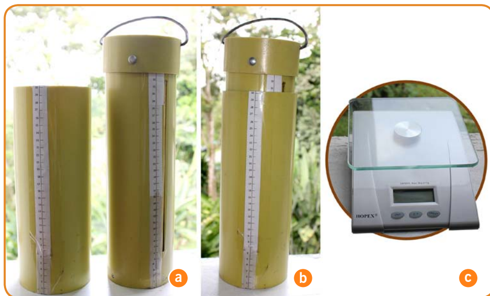
Figura 1. Componentes del método Gravimet-SM. a. Cilindro externo o porta receptor y cilindro interno receptor de granos; b. Cilindros en posición de trabajo; c. Balanza digital.
