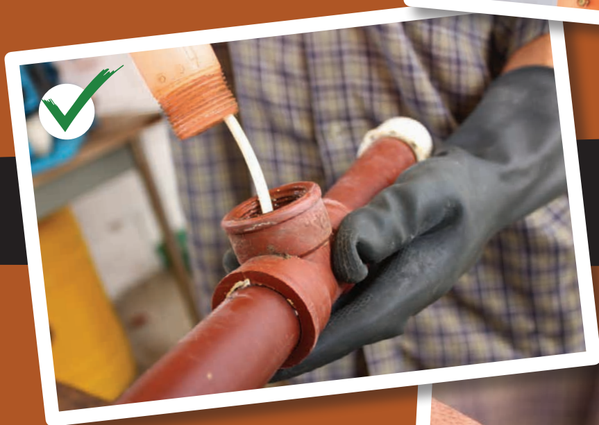
Figura 7. Revisión de la manguera de entrada de aire, la cual debe llegar hasta la base del selector, por debajo de los orificios de salida.
