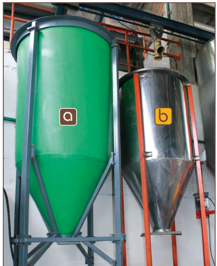
Figura 4. Tanques para la fermentación del mucílago del café fabricado en polietileno de densidad media (a) y en acero inoxidable AISI 430 (b).
