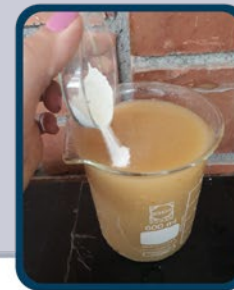
Adición de 4 kg de hidróxido de calcio por 1 m 3 de agua residual generada
