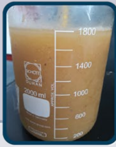
Agua residual del café proveniente del tanque tina
