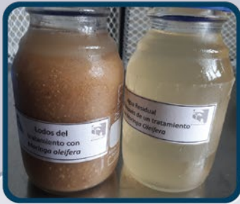
Separación del agua residual tratada y del material sólido
