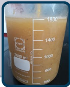
Agua residual del café proveniente del tanque tina
